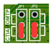
При использовании гарнитуры стандарта ОМТР установите перемычки следующим образом:
